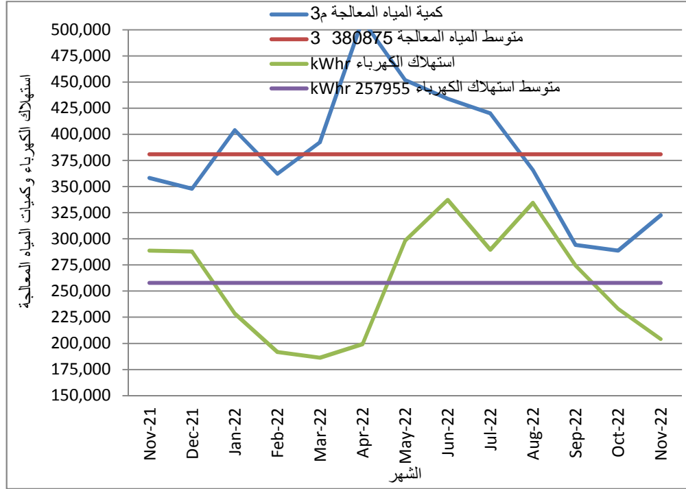
18: يوضح قيمة استهلاك الكهرباء وكمية المياه المعالجة 2022/11 2021/11
