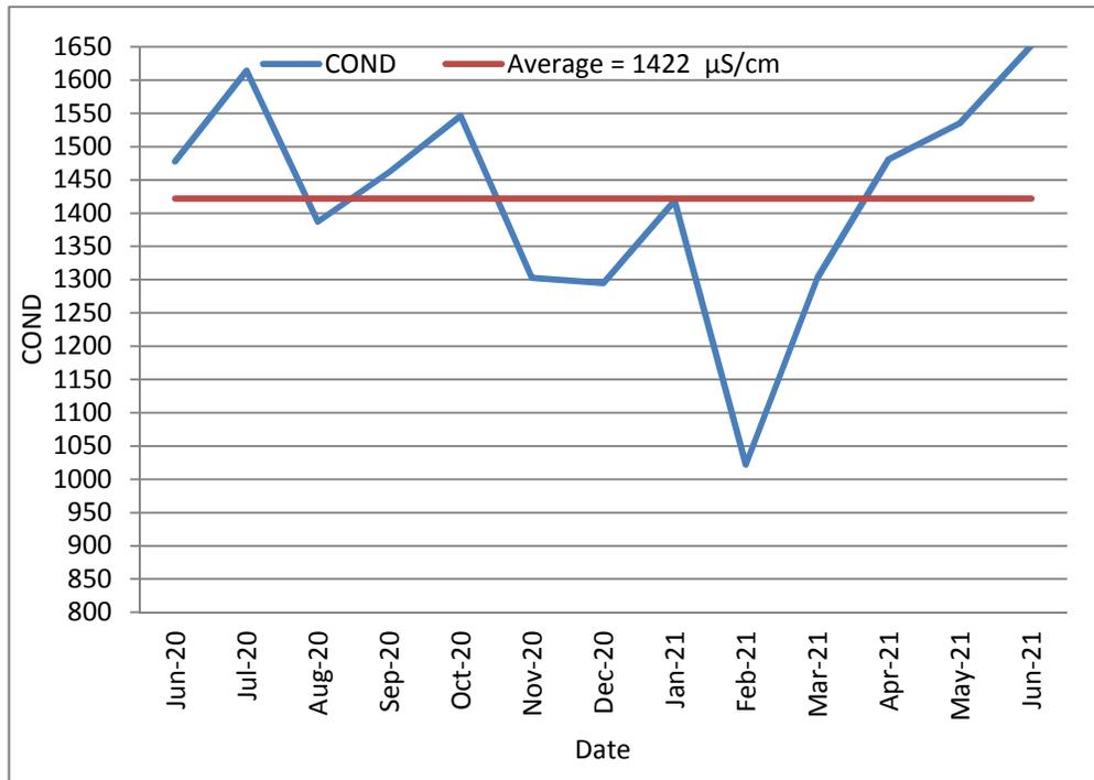
13 : يوضح قيم الموصلية الكهربائية (Conductivity) للمياه العادمة الداخلة 2020/6 2021/6
