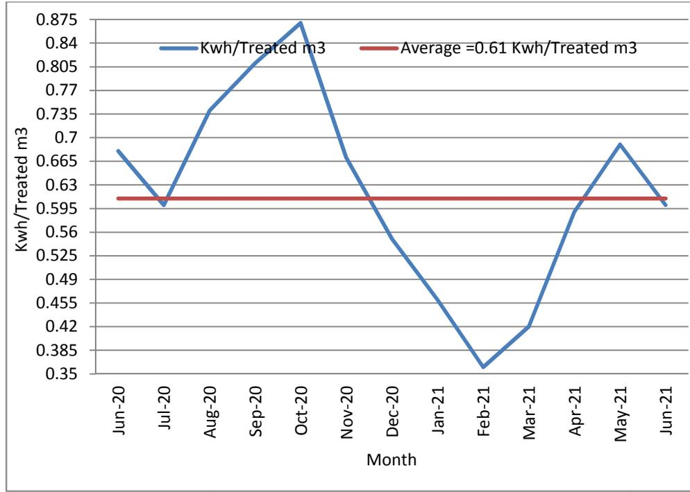
2021/6 2020/6 يوضح كميات الطاقة الكهربائية المستخدمة بدلالة كيلو واط ساعة لكل متر مكعب مياه معالجة
