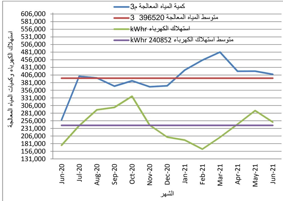
18: يوضح قيمة استهلاك الكهرباء وكمية المياه المعالجة 2021/6 2020/6
