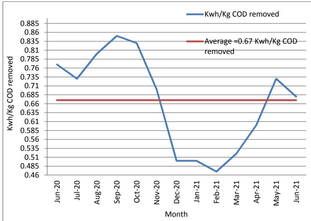
19: يوضح كميات الطاقة الكهربائية المستخدمة بدلالة كيلو واط ساعة لكل كغم COD 2021/6 2020/6
