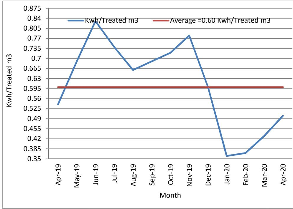
2020/4 2019/4 يوضح كميات الطاقة الكهربائية المستخدمة بدلالة كيلو واط ساعة لكل متر مكعب مياه معالجة 20
