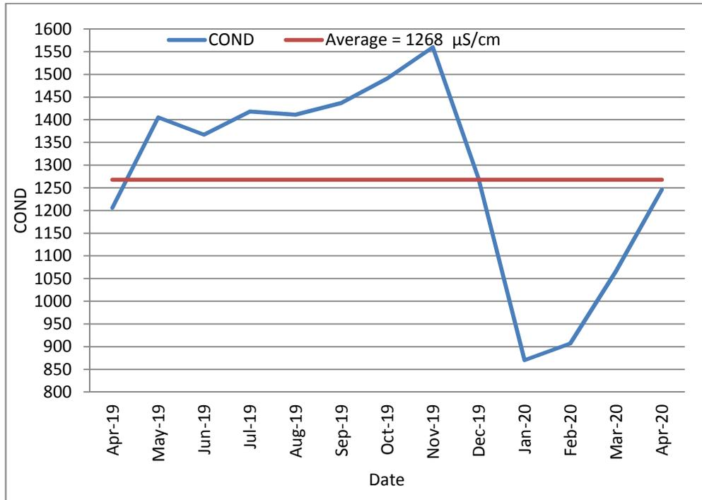
13 : يوضح قيم الموصلية الكهربائية (Conductivity) للمياه العادمة الداخلة 2020/4 2019/4
