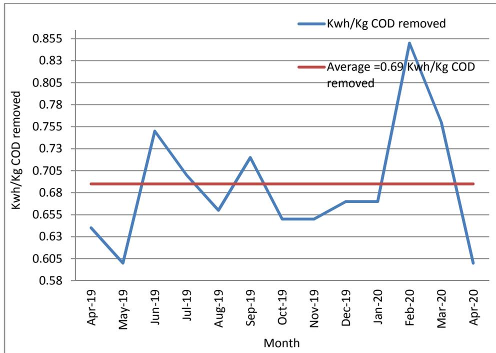
19: يوضح كميات الطاقة الكهربائية المستخدمة بدلالة كيلو واط ساعة لكل كغم COD 2020/4 2019/4
