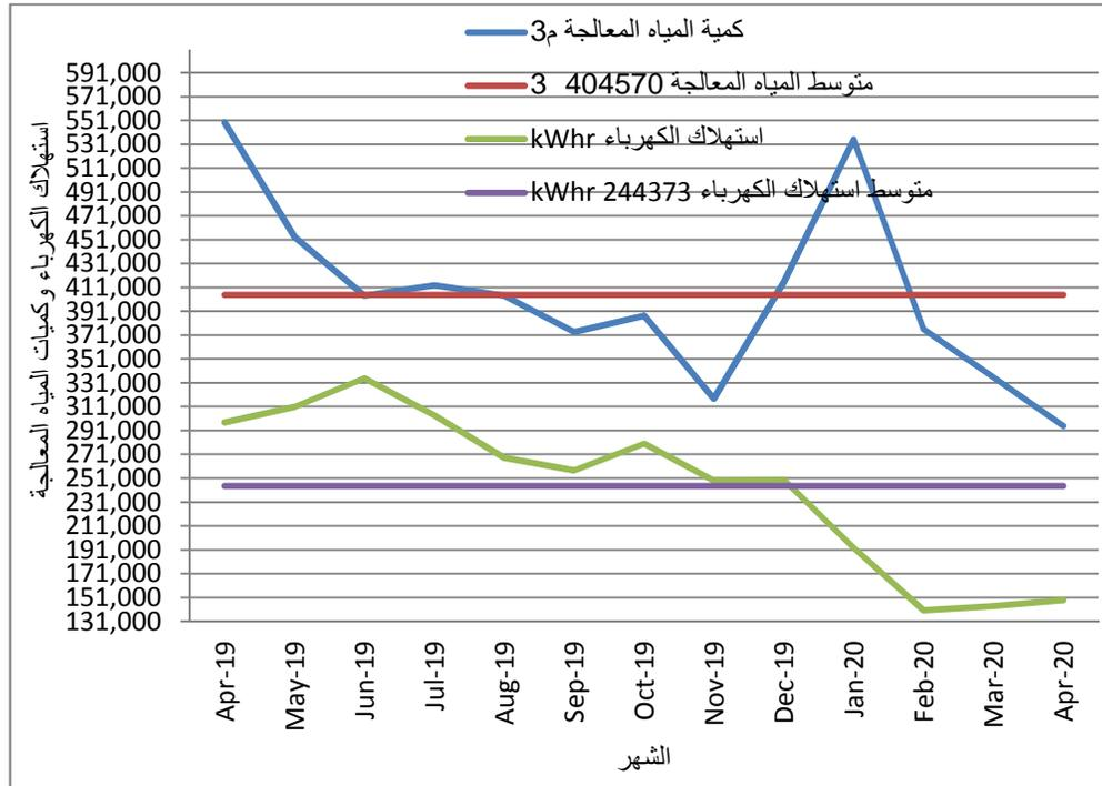
18: يوضح قيمة استهلاك الكهرباء وكمية المياه المعالجة 2020/4 2019/4
