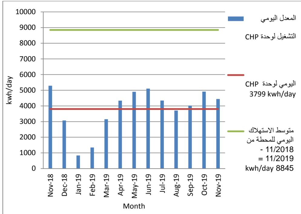
الاستهلاك اليومي للطاقة الكهربائية للمحطة مع انتاج الكهرباء من وحدة CHP
