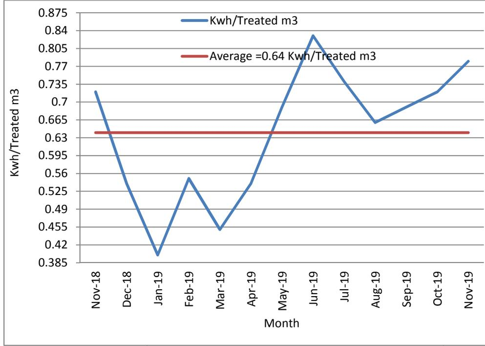
2019/11 2018/11 20: يوضح كميات الطاقة الكهربائية المستخدمة بدلالة كيلو واط ساعة لكل متر مكعب مياه معالجة
