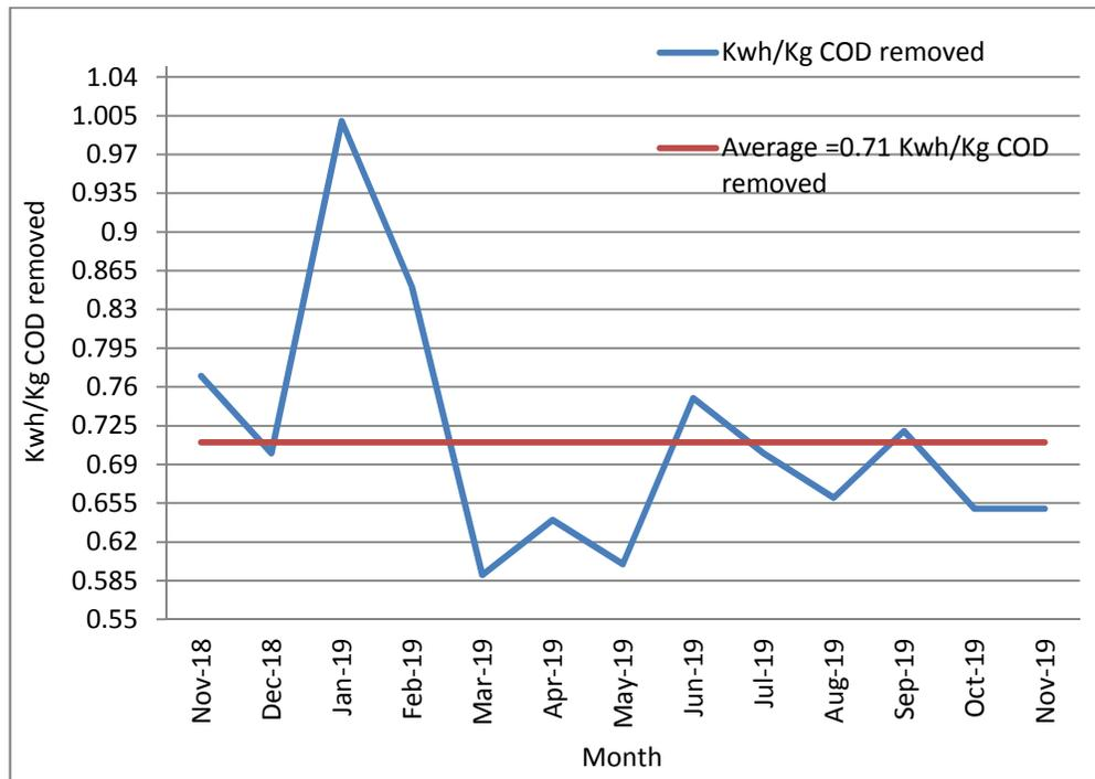
19: يوضح كميات الطاقة الكهربائية المستخدمة بدلالة كيلو واط ساعة لكل كغم COD 2019/11 2018/11
