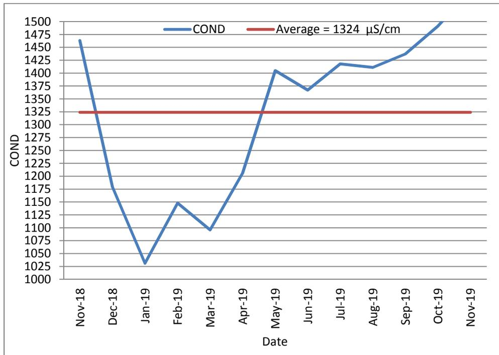
13 : يوضح قيم الموصلية الكهربائية للمياه العادمة الداخلة (Conductivity) 2019/11 2018/11
