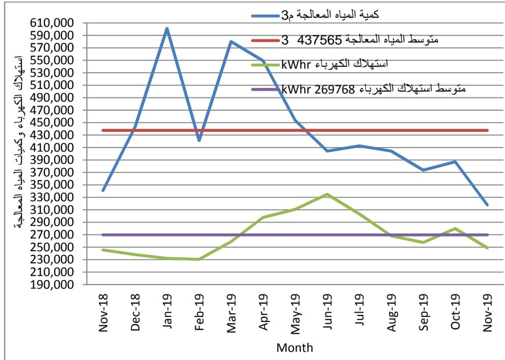
18: يوضح قيمة استهلاك الكهرباء وكمية المياه المعالجة 2019/11 2018/11
