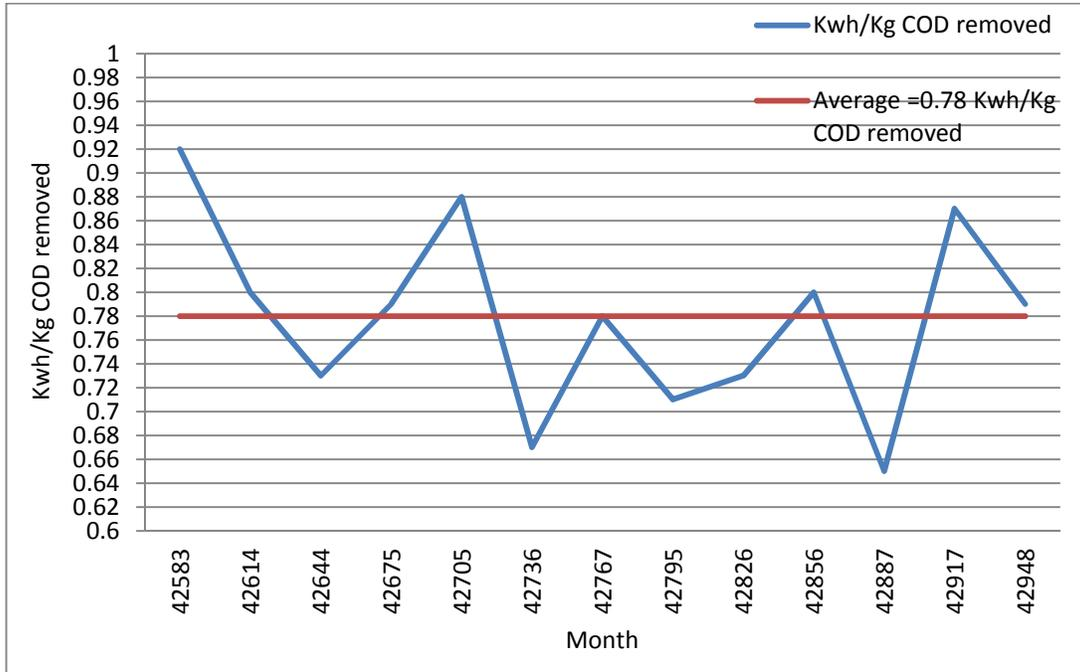
(18) : الطاقة الكهربائية المستخدمة بدلالة كيلو واط ساعة لكل كغم COD
