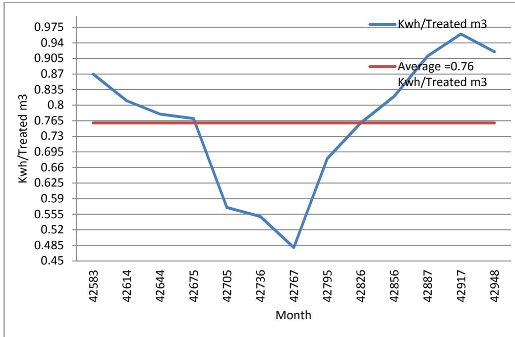
(19) : كميات الطاقة الكهربائية المستخدمة بدلالة كيلو واط ساعة لكل متر مكعب مياه معالجة
