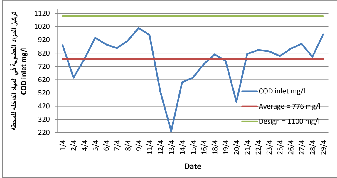
شكل (6) : تركيز المواد العضوية في المياه العادمة الداخلة للمحطة
